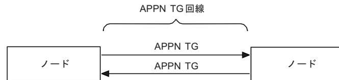
図 11. 2 つの拡張対等通信ネットワーク (APPN) TG によって形成される拡張対等通信ネットワーク (APPN) TG 回路
